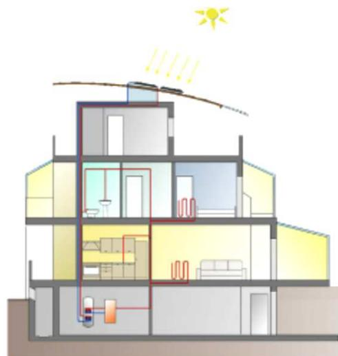
Schema di funzionamento di un impianto solare a circolazione forzata
