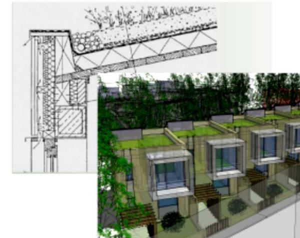
Sezione tipo e progetto con l'inserimento di copertura a verde
